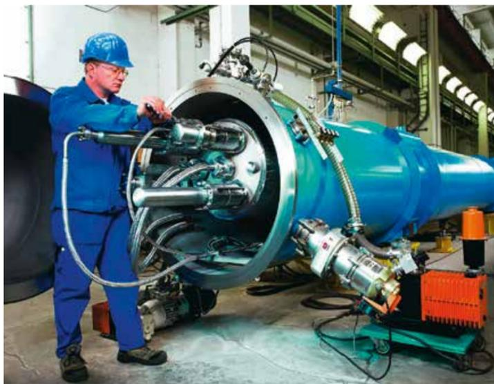
Bilfinger montiert Hightech-Magnete für die Genfer Cern Versuchsanlage. © Bilfinger
