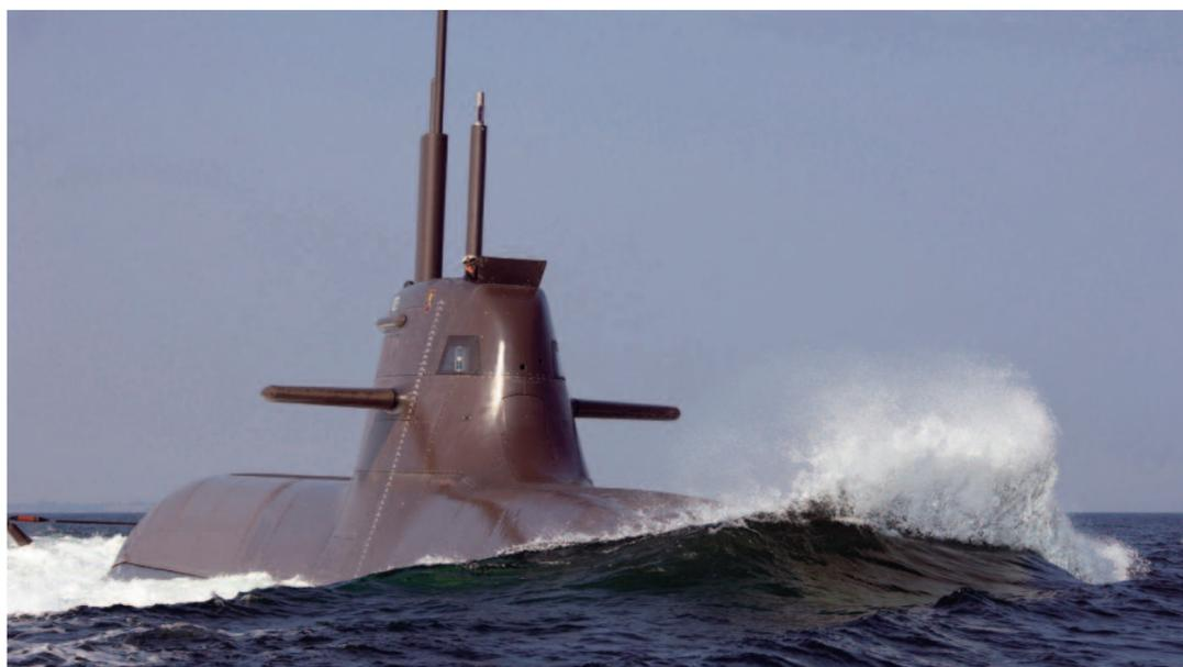
Die deutschen U-Boote der Klasse 212 A mit Brennstoffzellen-Antrieb haben ein breites Einsatzspektrum. © ThyssenKrupp
