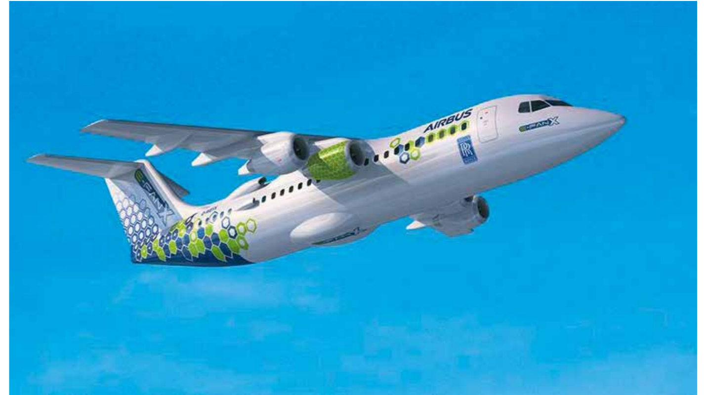
Die E-Fan X wird voraussichtlich 2021 ihren Erstflug für den Test eines 2 MW Hybrid-Elektroantriebs durchführen. © Rolls-Royce
